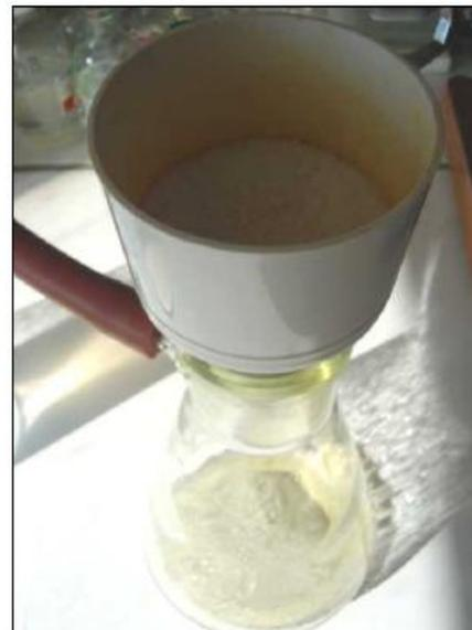
**Ajouter une troisième fois** 20 mL d'eau froide dans le ballon, puis remuer de façon à décoller ce qui reste. Verser le contenu du ballon dans le Buchner.
