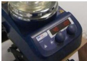
**Allumer** l'agitateur magnétique. (Appuyer sur l'interrupteur situé sur le côté gauche)
