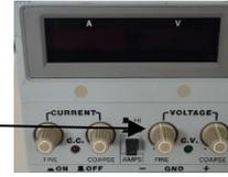
faire varier la tension aux bornes du générateur  $U_G$  de 0 V à 2,5 V et mesurer à chaque fois les valeurs de l'intensité  $I$  traversant la DEL et la tension  $U_D$  à ses bornes.
